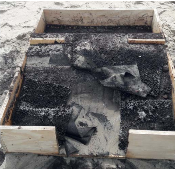
Figuur 8c – Effect combinatie geotextiel en 3D mat zonder goede verankering van de kleine proefstukken van 30 x 30 cm onderling.
