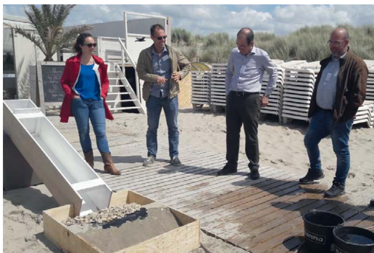
Figuur 5 – De proefopstelling met golfgoot en proefbak met een van de proefmodellen.
