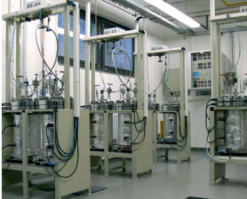
Figuur 3 – Autoclaaftest voor langeduur- gedrag (bron: Dr M. Boehning BAM 6.6).
