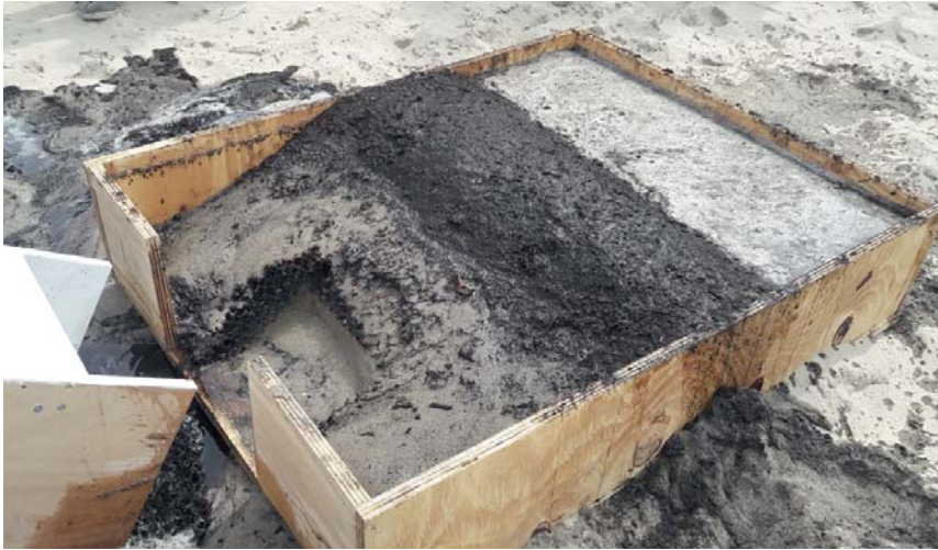
Figuur 8a – Teelaarde in 3D mat: talud bleef heel, wel veel overslag.
