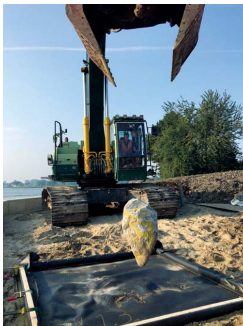
Figuur 1 – Uitvoering gestandaardiseerde valproeven op geotextiel filter laag, met beproevings weefsels, non-wovens en composieten, proeflocatie Gorinchem, september 2020.
