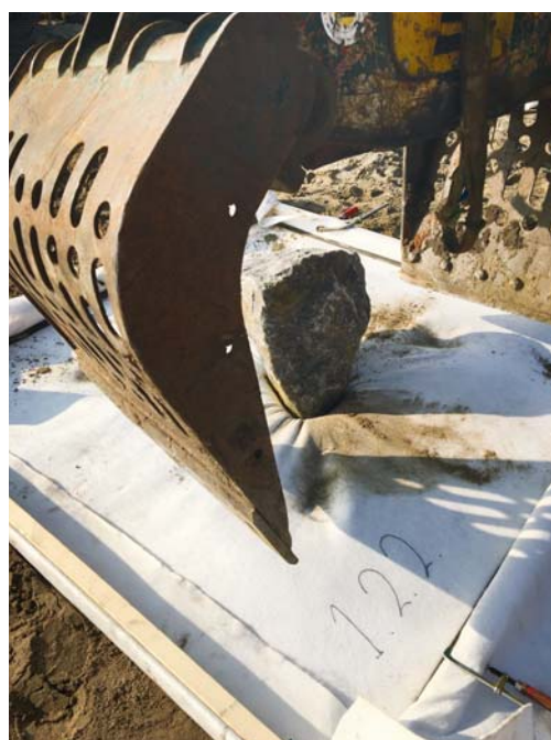
Figuur 2 – Gestandaardiseerde valproef op non-woven geotextiel filter laag en beoordeling schadepatroon, proeflocatie Gorinchem, september 2020.
