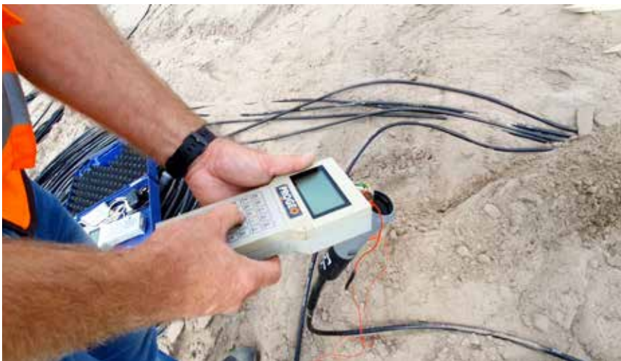
Met Geologger kan eenvoudig worden vastgesteld of de afdichtingsconstructie nog intact is.
