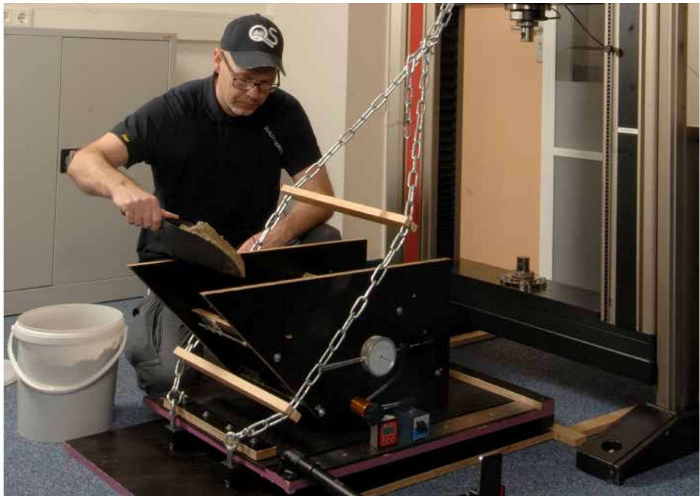
De afschuiftest geeft inzicht in de steilste helling die met het gewenste pakket van grond- en geokunststof producten mogelijk is.
