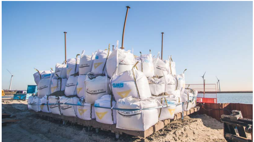
Figuur 5 – Proefbelasting, belastingoppervlak is 3 \times 6 \text{ m}^2 , oppervlakte bigbags = 5 \times 8 \text{ m}^2 .
