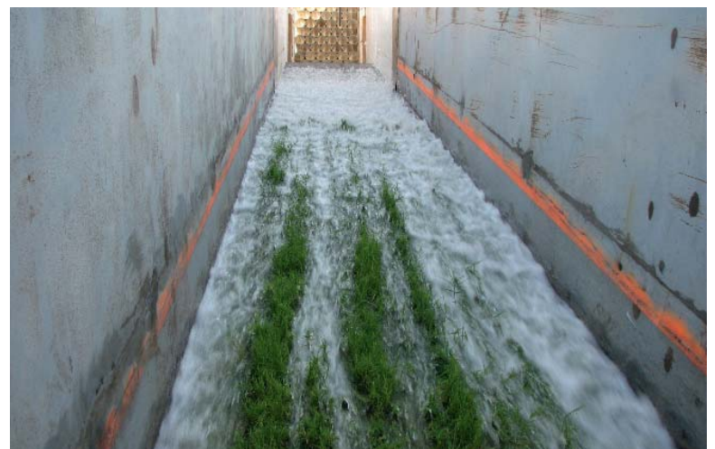
Figuur 3 – Uitvoering stroomproeven op grasvegetatie versterkt met een 3D open structuurmat (EnkaMat 7020, flow channel testing Colorado State University US). Referentie: Low & Bonar
