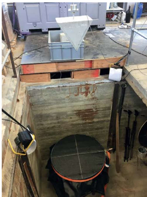
Figuur 6 – Uitvoering van valproeven op composiet geotextiel (woven/non-woven).
