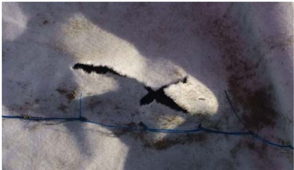
Figuur 8 – Veldproef. Rechts: voorbeeld van schade aan het onderste geotextiel (vlies) bij een test met twee lagen. (Foto's Van den Herik)
