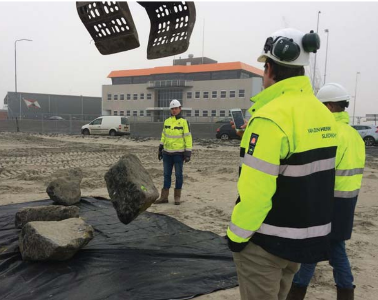
Figuur 8 – Veldproef. Rechts: voorbeeld van schade aan het onderste geotextiel (vlies) bij een test met twee lagen. (Foto's Van den Herik)
