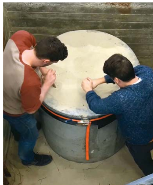
Figuur 2 – Losmaken van de bovenste 0,3 m van het zand na een valproef zodat de dichtheid van het zand bij de verschillende proeven min of meer gelijk is.
