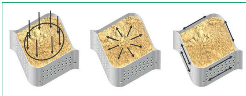
Figuur 2 – Schematisatie van spanningen in een geocell [bron: CUR/CROW C1001].
