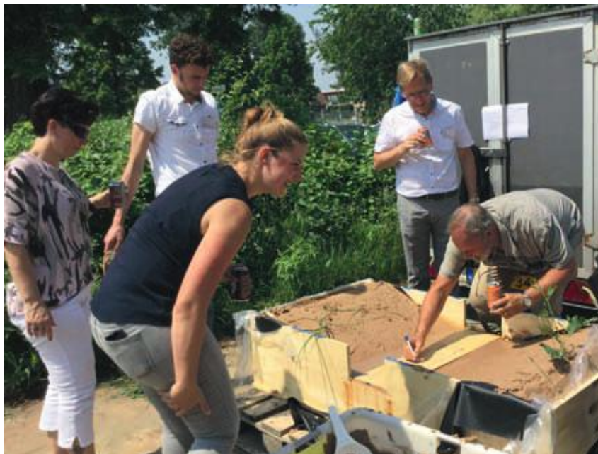
Figuur 1 – Proefopstelling bouwen: bouw een verdiepte weg die droog blijft terwijl het grondwater wordt verhoogd tot aan maaiveld.
