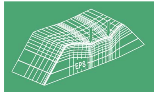
Figuur 1 Driedimensionaal verhardingsmodel berekend met het CAPA-3D programma
