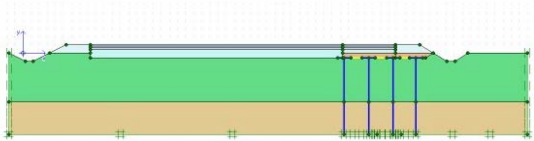
Figuur 4.3 – Model van de dwarsdoorsnede van de snelweg inclusief op betonpalen gesteunde wegverbreiding.
